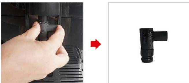
**4-й крок:** Розберіть блок спінювання молока, з'єднувач та інші компоненти, промийте їх під проточною водою.
